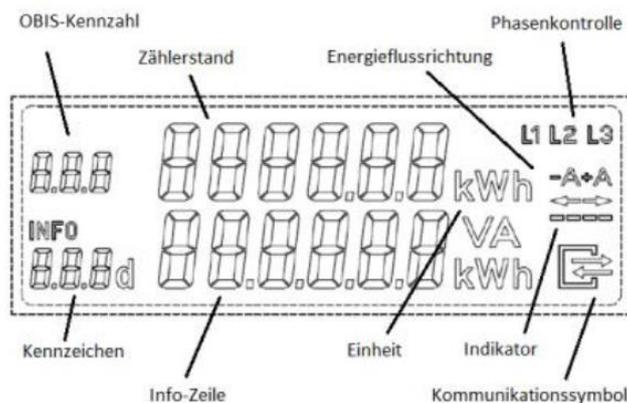
In der oberen Zeile werden abrechnungsrelevante Zählerstände in kWh angezeigt. Die OBIS-Kennzahl gibt dabei das entsprechende Register an. Register 1.8.0 (A+) zeigt Ihren Gesamtverbrauch und Register 2.8.0 (A-) die von Ihnen eingespeiste Energiemenge, bspw. durch den Betrieb einer PV-Anlage. Kunden ohne Eigenerzeugung wird daher immer der Wert 0 kWh angezeigt.
