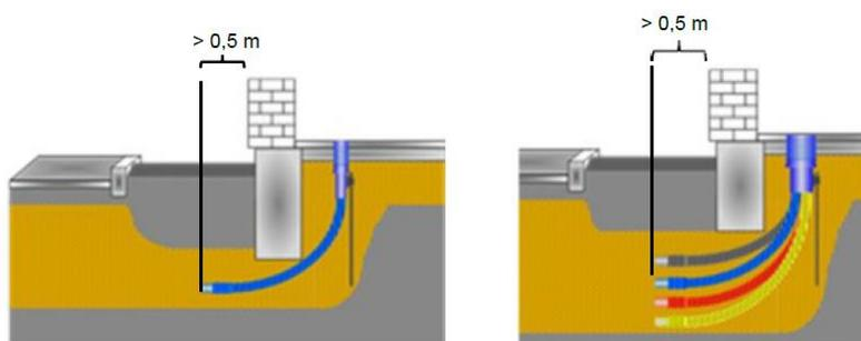
Gebäudeeinführungen sind nach den geltenden Vorschriften für Bauwerksdurchdringungen und deren Abdichtung für erdverlegte Leitungen auszuführen. Die Gebäudeeinführung ist Bestandteil des Gebäudes.
